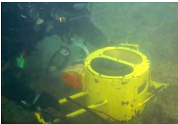
Abb. 2.3: Probenahme mit dem UW-Sampler durch einen Taucher
