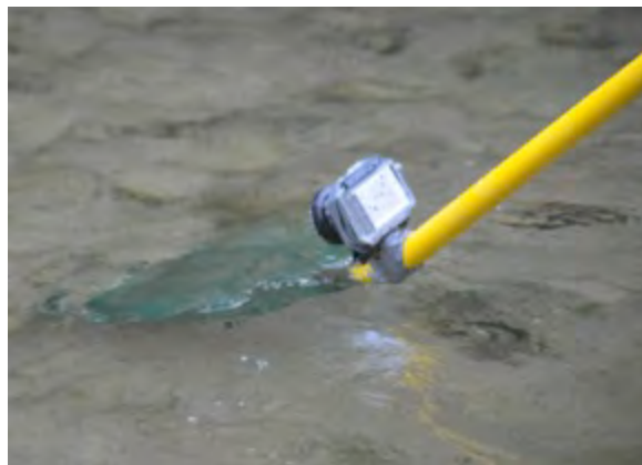
Abb. 2.8: Unterwasserbeobachtungen mit der Anodenkamera
